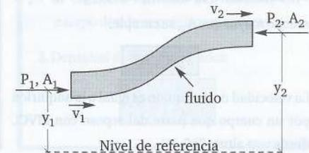
En la figura anterior se muestra la porción de un fluido que se mueve por la sección variable de un conducto (tubo) de la posición (1) hasta la posición (2). La ECUACIÓN DE BERNOULLI es:
